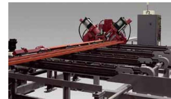
12m長尺材もチェーンコンベア上に降すだけで自動的に定寸装置にセットします。標準仕様の他、お客様のご要望に合わせたカスタマイズ仕様にも柔軟にお応えしています。
