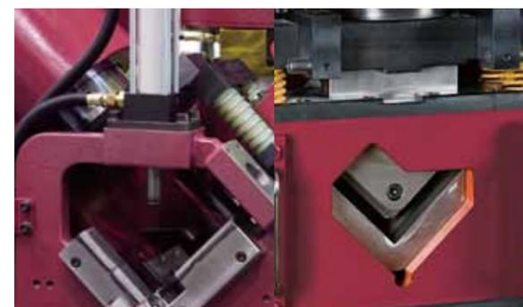
穴あけ用パンチ金型、切断用カット金型はいずれもユニット金型方式。加工内容や鋼種に応じた金型交換がとて速く簡単に行えますので、段取り時間が大幅に短縮されます。
