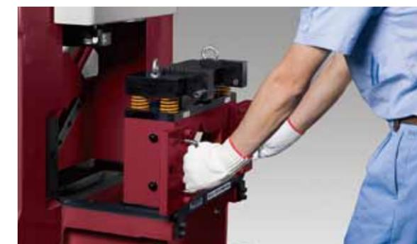
金型装着ボルト2本を外すだけで金型交換が行えます。面倒なクリアランス調整も事前に行えますので、金型交換作業に要する時間はわずか10分程度です。(当社計測値)
