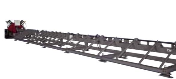
加工データ情報に応じて製品長さ別に自動搬出します。次工程の作業の効率化のため、1.5m以下の短尺、4.5mまでの中尺、12mまでの長尺の3種類に分けて排出します。
